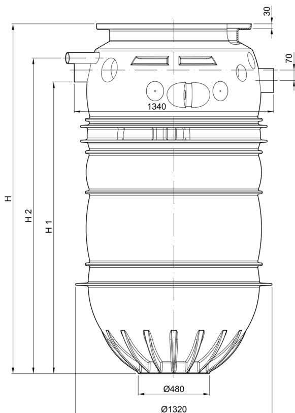
Anschlussmuffen DN 100 für bauseitige Füll- bzw. Lüftungsleitung (optional zu öffnen)
